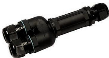
Giunzione stagna IP68 a tre vie "Y" 5 poli, per cavo con diametro esterno minimo 7mm e massimo 13,5 mm.
